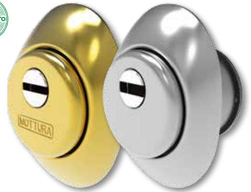
La copertura del **Defender®** e il rivestimento della mostrina in alluminio/ottone permettono **8 finiture** diverse per il miglior abbinamento possibile con maniglie e pomoli esistenti. L'entrata chiave è protetta da rondella rotante in acciaio cromato con feritoia entrata chiave disponibile in **due misure 3,5 oppure 5 mm.**
