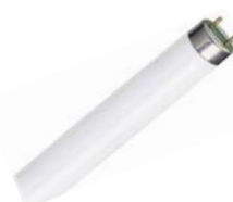
HYZ36DL/B (H061) TRIFOSFORO CRI 82 T8 6500K (EN BLISTER), G13, 36W, 2950LUMS, 10000H, 1213.6 LONG, 26Ø
