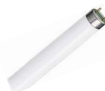
HYZ36CW/B (H132) TRIFOSFORO CRI 82 T8 4000K (EN BLISTER), G13, 36W, 3150LUMS, 12000H, 1213.6 LONG, 26Ø
