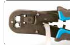
Corte de cables de red
